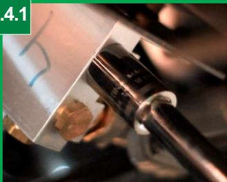
É possível retirar o ar de duas maneiras, nesse primeiro exemplo, retire de uma válvula de distribuição, essa válvula está interligada com a válvula 4 vias que é encontrada em todos os veículos, a válvula 4 vias possui uma numeração e os números corretos para acessórios são 24 ou 26.
