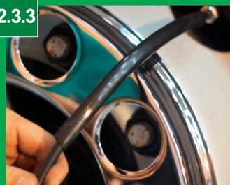
Coloque mangueira de proteção se o tubo ficar em contato com alguma extremidade.
