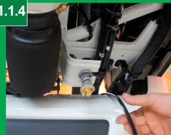
Primeiramente é passado os tubos para rede traseira, se a retirada do ar for feita de baixo da cabine ou atrás da mesma, é passado o tubo de ar junto com o tubo traseiro.
