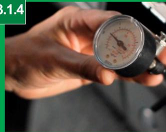
No tubo do ar direto coloque o manômetro aferidor, ligue o veículo e deixe o compressor carregar para ver quantas libras possui, para o bom funcionamento do rodocalibrador é recomendado deixar sempre no mínimo 20 lbs a mais do que a calibragem máxima desejada nos pneus, se isso não ocorrer é necessário aumentar a pressão de descarga do compressor, esse serviço é feito de preferência em uma rede autorizada.
