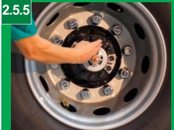
Observe que os bicos do cinemático ficaram posicionados conforme os bicos da câmara. Ligue os tubos de nylon dos prolongadores aos bicos do cinemático, lembre-se de colocar as mangueiras de proteção quando necessário.
