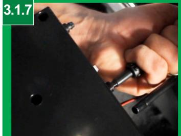
Pegue o tubo com a marcação 3 e ligue na conexão central do painel.
