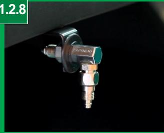
No eixo dianteiro serão colocados os sextavados sempre no centro do eixo, isso para que o cano não force no pneu quando for feito movimento na direção do veículo.
