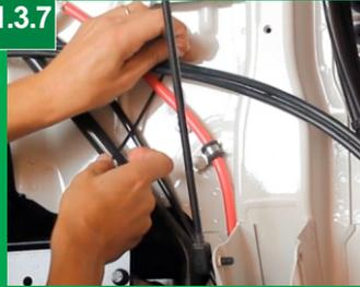
Fixe os tubos ao chicote elétrico ou hidráulico de modo a proteger as tubulações.
