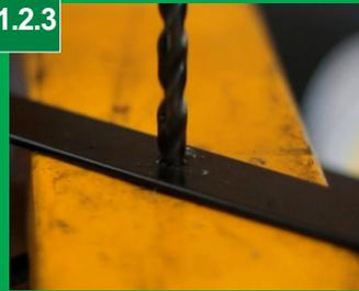
Após marcado o local, fure o suporte com auxílio de uma furadeira utilizando uma broca de acordo com o tamanho do parafuso do suporte do veículo.
