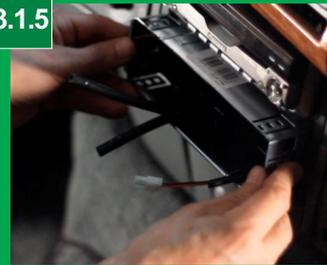
Para esse veículo será utilizado um Painel Slim Universal. Desta forma, coloque a cinta em uma das gavetas destinadas ao rádio.
