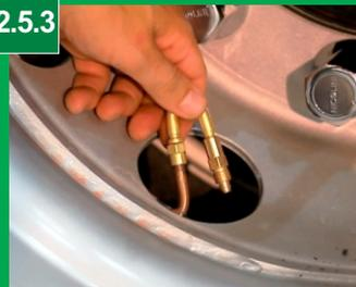
Coloque o bico curvo já montado no bico da câmara e aperte até dar vedação, posicione o bico curvo e aperte o bico da câmara.
