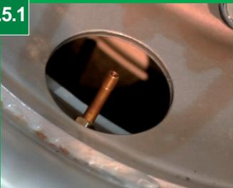
Para os pneus de fora é necessário a colocação dos bicos curvos. Solte o bico da câmara e vire-o para facilitar a instalação do bico curvo. Retire a válvula do bico da câmara (ventil).
