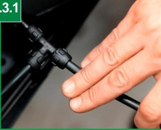
Primeiramente passe os tubos de nylon ligando um rodado ao outro. Utilizando os tees de nylon, faça a ligação da rede dos eixos com a rede central que foi passada no início da instalação.
