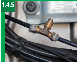
Neste segundo exemplo utilize o tee de ar com anilha, corte o tubo que tenha ligação com a válvula 4 vias, para saber se ela está interligada, ao cortar o ar o manômetro que marca a pressão de ar do veículo cairá até mais ou menos 6,5 bar, isso é suficiente para que o veículo trafegue com segurança em caso de rompimento, caso contrário não utilizar essa tubulação.
