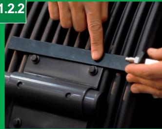
Iniciando a instalação pela tração, coloque o sextavado ao suporte e meça no veículo onde deverá ser furado.
