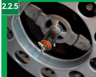
Coloque o cinemático na flange rosqueando até o aperto, deixe a arruela de pressão entre a flange e a porca. Com uma chave de boca aperte a porca  $\frac{3}{4}$  deixando o bico do cinemático em direção ao bico da câmara.
