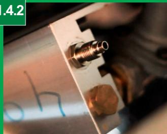
Após retire o tampão e coloque a conexão própria para o rodoalibrador.
