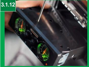
O alarme do painel precisa acionar entre 10 e 15 lbs abaixo da calibragem escolhida para os pneus. Para regular o alarme utilize uma chave Phillips nos parafusos localizados na parte de cima dos manômetros, no caso do alarme a regulagem é ao contrário do regulador, apertando diminui e soltando aumenta.
