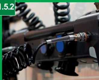
Na mangueira espiral coloque as molas para espiral e em uma das extremidades o bujão do engate, na outra ligue ao sextavado. Para mangueira não ficar solta sobre a plataforma, plugue no pino de descanso.
