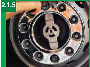
Coloque novamente a calota que poderá ser substituída pelo modelo cromado. Coloque novamente as porcas e aperte bem com a chave de roda.
