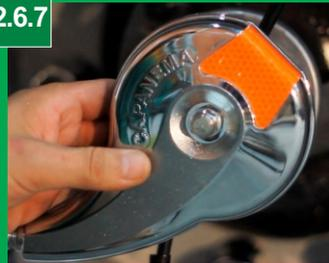
Encaixe a mola na porca, coloque a arruela na ponta do eixo e aperte a calota com a porca cromada. Proceder da mesma maneira nos demais eixos.
