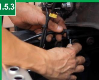
Corte o tubo de nylon que foi passado anteriormente para rede traseira e coloque um tee de nylon.
