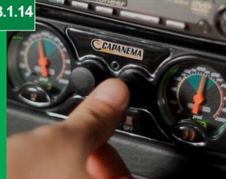
Após encaixar o painel deixe o veículo ligado e as chaves de ar na posição 2 para encher os pneus descalibrados.
