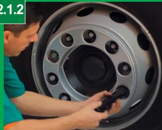
Com o auxílio da chave de roda, retire as porcas que seguram a calota.
