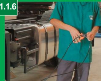
Corte os tubos na medida suficiente para que cheguem até o local onde será instalado o painel.
