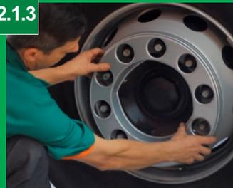
Retire a calota para colocação da flange.
