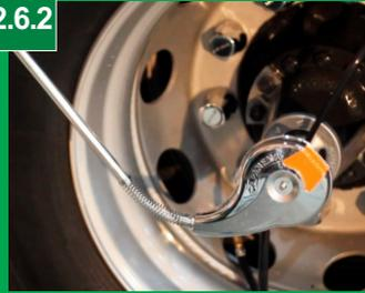
Coloque a calota no cinemático e verifique a altura necessária, preste atenção em veículos que estão carregados, pois após a descarga a suspensão tende a subir e os conjuntos também poderão sofrer elevação e conseqüentemente arrebentarem.
