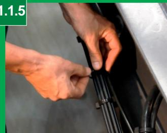
Procure sempre seguir o chicote elétrico e hidráulico do veículo, não deixe os tubos encostarem em componentes que aqueçam, por isso é importante prender bem os tubos utilizando as abraçadeiras fitas enviadas no kit.
