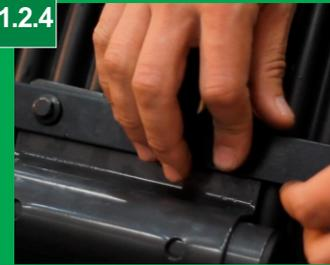
Retire os parafusos do suporte do veículo e coloque o suporte para sextavado fixando ambos com os mesmos parafusos retirados.
