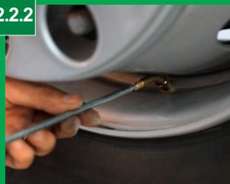
Com um saca ventil retire a válvula do bico.
