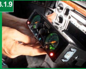
Ligue o veículo para completar o ar e verificar quantas libras está marcando no manômetros. Os painéis Nicolini Capanema saem de fábrica pré regulados com 90 lbs nos pneus dianteiros e 110 lbs nos pneus traseiros.
