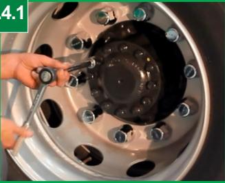
Retire as porcas dos parafusos do cubo conforme a furação da flange.
