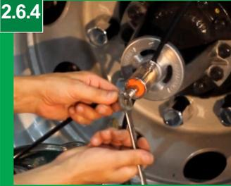
Após montado o conjunto, passe o tubo pelos canos e ligue primeiramente no eixo do cinemático apertando com a porca multiuso.
