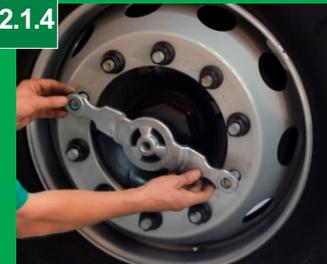
Coloque a flange nos parafusos da roda em que foram retiradas as porcas.
