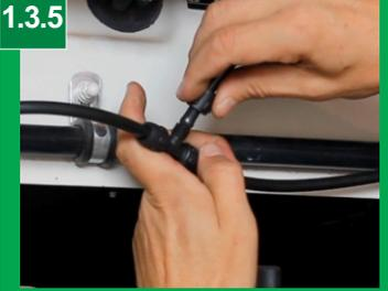
Para o eixo dianteiro, proceda da mesma maneira que nos eixos traseiros passando os tubos de um lado para o outro e ligando aos sextavados, como feito na rede traseira, coloque um tee na rede dianteira para levar o tubo até o painel.
