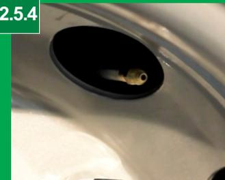
Retire a válvula (ventil) do pneu interno e coloque o prolongador apertando até dar vedação, em alguns casos se o bico for muito curto pode-se colocar extensões para facilitar a colocação dos tubos.
