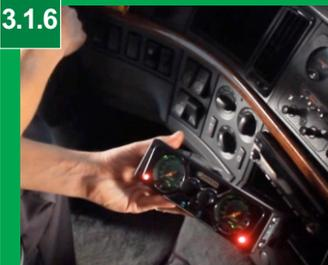
Antes de instalar o painel, conecte o chicote e verifique se as luzes e o alarme funcionam.
