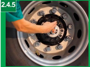
Posicione os bicos do cinemático na direção dos bicos da câmara.
