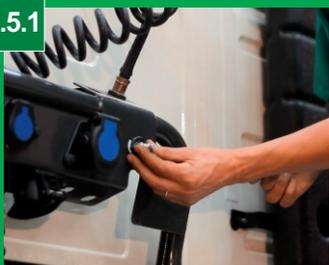
Atrás da cabine se encontra a plataforma e o suporte onde está o chicote elétrico e as espirais do freio para o semi-reboque. Utilize o mesmo suporte para colocação do sextavado e do pino de descanso.
