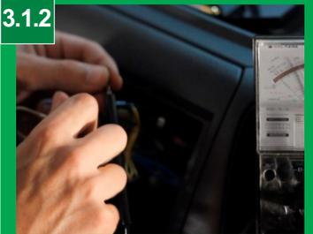
Com uma chave teste, procure um fio terra e um positivo pós chave. Para ligar o chicote do painel, ligue o fio preto ao terra e o fio vermelho ao positivo.
